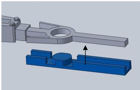
Zur Verwendung des Normschachtes das Füllstück unter die Aufnahme kleben.
